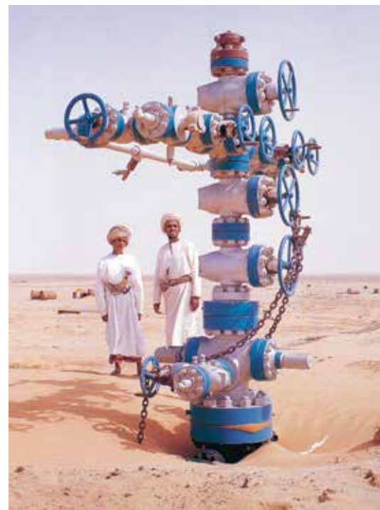
FIG. 9 Julgran på Yibal 1, Oman, 1962. Första källan borrard av PD (Oman) under Shells ledning och den första som indikerade olja i Oman /Christmas tree on Yibal 1, Oman in 1962. The first well drilled by PD (Oman) under the aegis of Shell and the first to give indications of oil in Oman.
